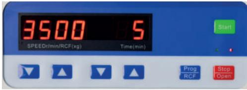
Pantalla LCD con parámetros de velocidad, temporizador y RCF
