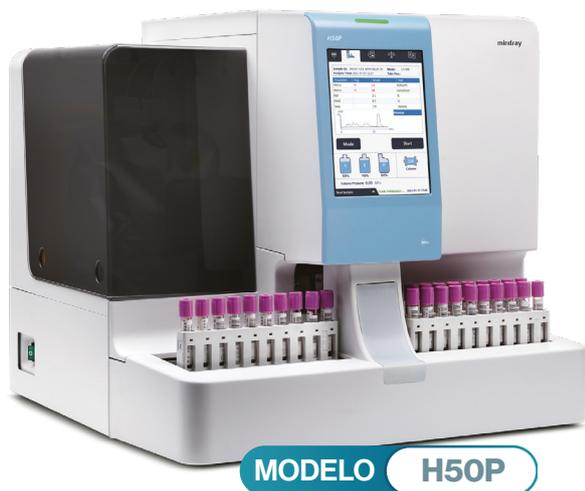
El modelo H50P, gracias a su método de pruebas Gold standard de Cromatografía Líquida de Alto Performance (HPLC) y un alto rendimiento de 50 muestras por hora destaca en la medición de hemoglobina glicosilada con mejor precisión.
